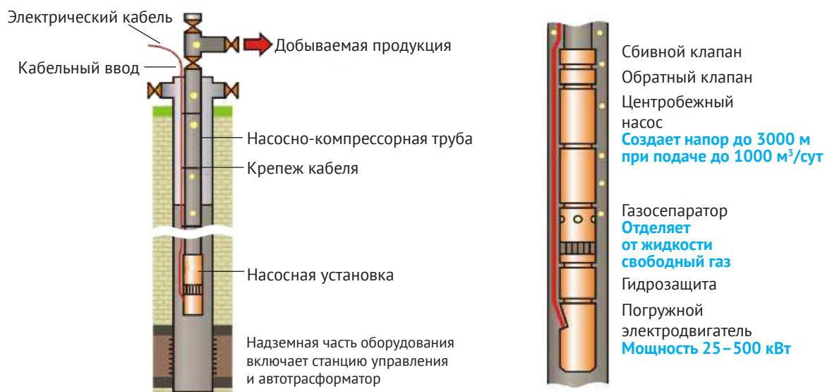
Рис. 50. Погружной электроцентробежный насос [present5.com]
